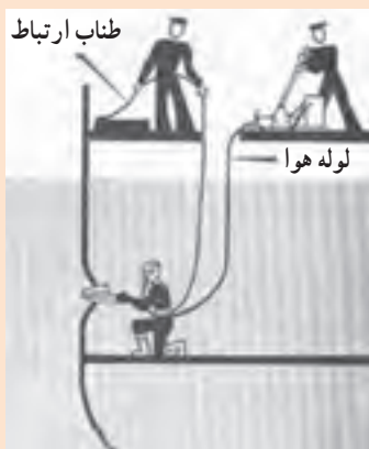
شکل ۳-۱- نحوه مسدود کردن سوراخ محوطه پر از آب
