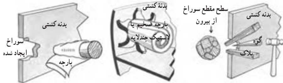
شکل ۵-۱۰- انواع گوه و نحوه مسدود کردن سوراخ به‌وسیله پلاک، گوه و پارچه
