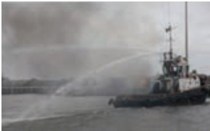
شکل ۱۱-۳ یک فروند یدک‌کش در حال استفاده از آتش‌خوارها جهت مبارزه با حریق شناور کنار اسکله
